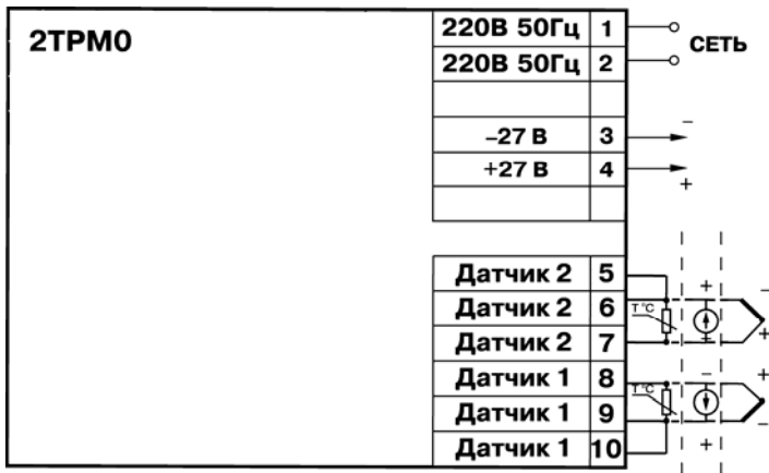
Рисунок Б.5 – Схема подключения к прибору 2ТРМ0 датчиков (для конструктивного исполнения в DIN-реечном корпусе)
