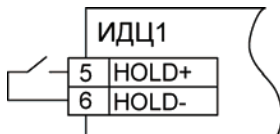
Рисунок 6.1 – Подключение коммутирующих устройств к контактам «HOLD»
