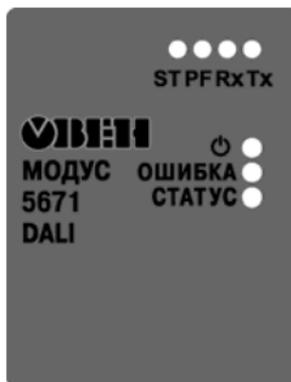
Рисунок 3.1 – Индикаторы модуля
