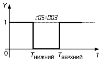
Рис. 3.17. Компаратор срабатывает вне установленных пределов
