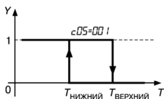
Рис. 3.15. Компаратор срабатывает по нижней уставке: Y = 1 - выходное реле замкнуто; Y = 0 - выходное реле разомкнуто
