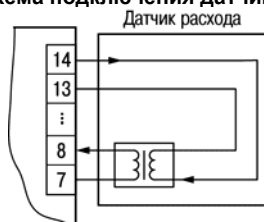
Рисунок Б.3 - Схема подключения датчика расхода, выполненного на дифференциальном трансформаторе
