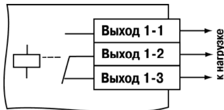
Рисунок Б.8 – Схема подключения нагрузки к ВУ типа Р (для первого ВУ)
