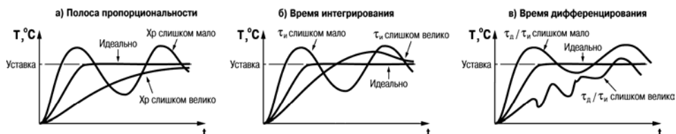
Рисунок Г.3 – Примеры графиков переходной функции
