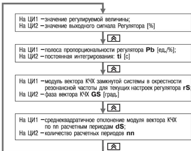
Рисунок 12.3 – Схема переключения индикации в режиме Автонастройки
