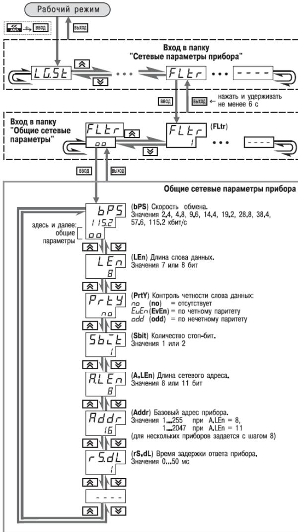
Рисунок 9.1 – Схема задания сетевых параметров прибора кнопками на лицевой панели прибора
