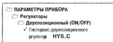
Двухпозиционный регулятор не нуждается в сложной настройке. Для него можно задать задержки включения и отключения, а также минимальные значения времени удержания во включенном и выключенном состоянии (см. Приложение I).
