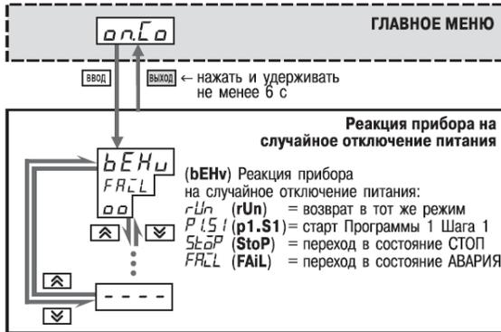
Рисунок 11.14 – Схема задания реакции на случайные отключения питания
