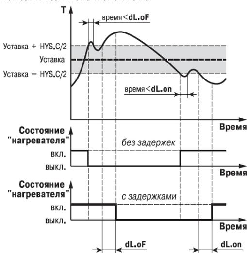
Рисунок И.1 – Работа двухпозиционного регулятора с задержками включения/выключения ИМ
