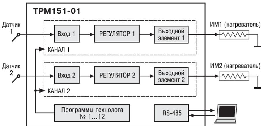
Рисунок 3.1 – Структурная схема TPM151-01
