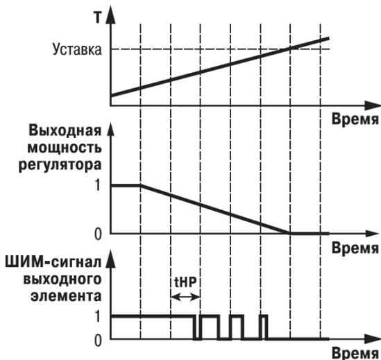
**Рисунок 3.5 – Принцип формирования ШИМ-сигнала для «нагревателя»**
