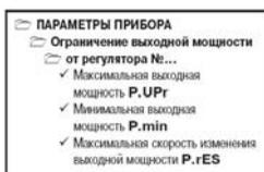
Ограничение диапазона выходной мощности Регулятора задается двумя параметрами: максимальное значение **P.UPr** и минимальное **P.min**. Эти параметры задаются в процентах от максимальной мощности, которую можно подать на Исполнительный механизм. Если Регулятор выдает значение мощности, находящееся за пределами заданного диапазона, то оно принимается равным **P.UPr** или **P.min** соответственно.
