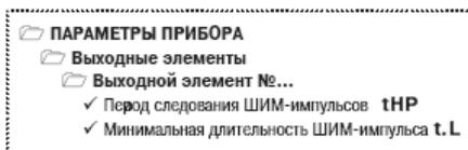
Чем выше частота управляющих импульсов (т. е. меньше период **tHP**), тем точнее реакция Регулятора на внешние изменения.
