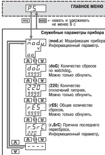
Рисунок 11.15 – Схема доступа к служебным параметрам прибора
