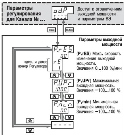
Рисунок 11.10 – Схема задания основных параметров конфигурации (продолжение). Задание ограничений выходной мощности
