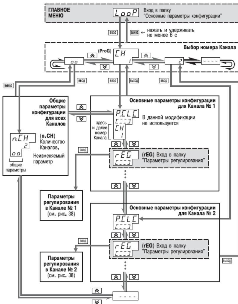
Рисунок 11.8 – Схема задания основных параметров конфигурации
