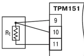
Рисунок Г.1 – Подключение ТС по трехпроводной схеме
