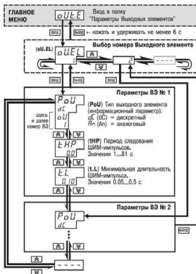
Рисунок 11.11 – Схема задания параметров Выходных элементов
