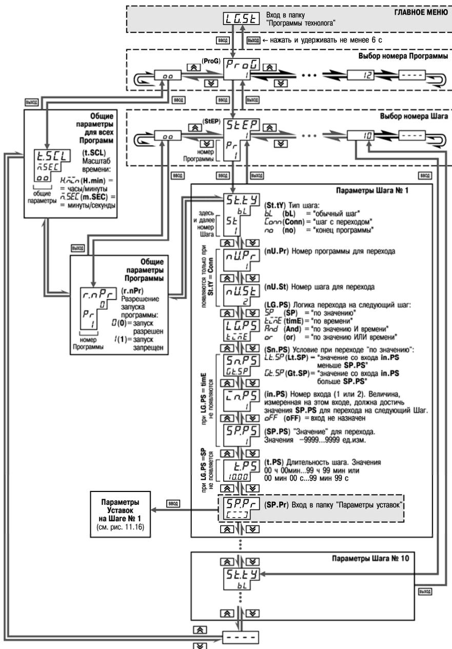
Рисунок 11.15 – Схема задания параметров Программ технолога и Уставок
