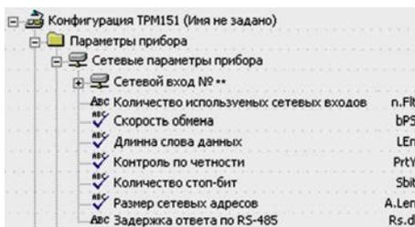
После записи в прибор измененных **Сетевых параметров прибора** Конфигуратор автоматически предлагает изменить **Сетевые параметры программы** (см. п. 9.4).
