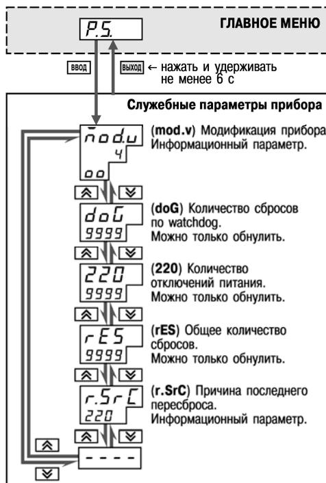
Рисунок 11.18 – Схема доступа к служебным параметрам прибора
