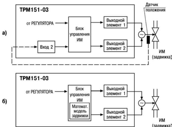
**Рисунок 3.5 – Управление 3-х позиционным ИМ:**
