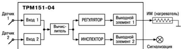
(Инспектор). Сигнал от Инспектора подается на Выходной элемент 2, к которому подключается средство аварийной сигнализации (лампа, звонок и т. д.).
