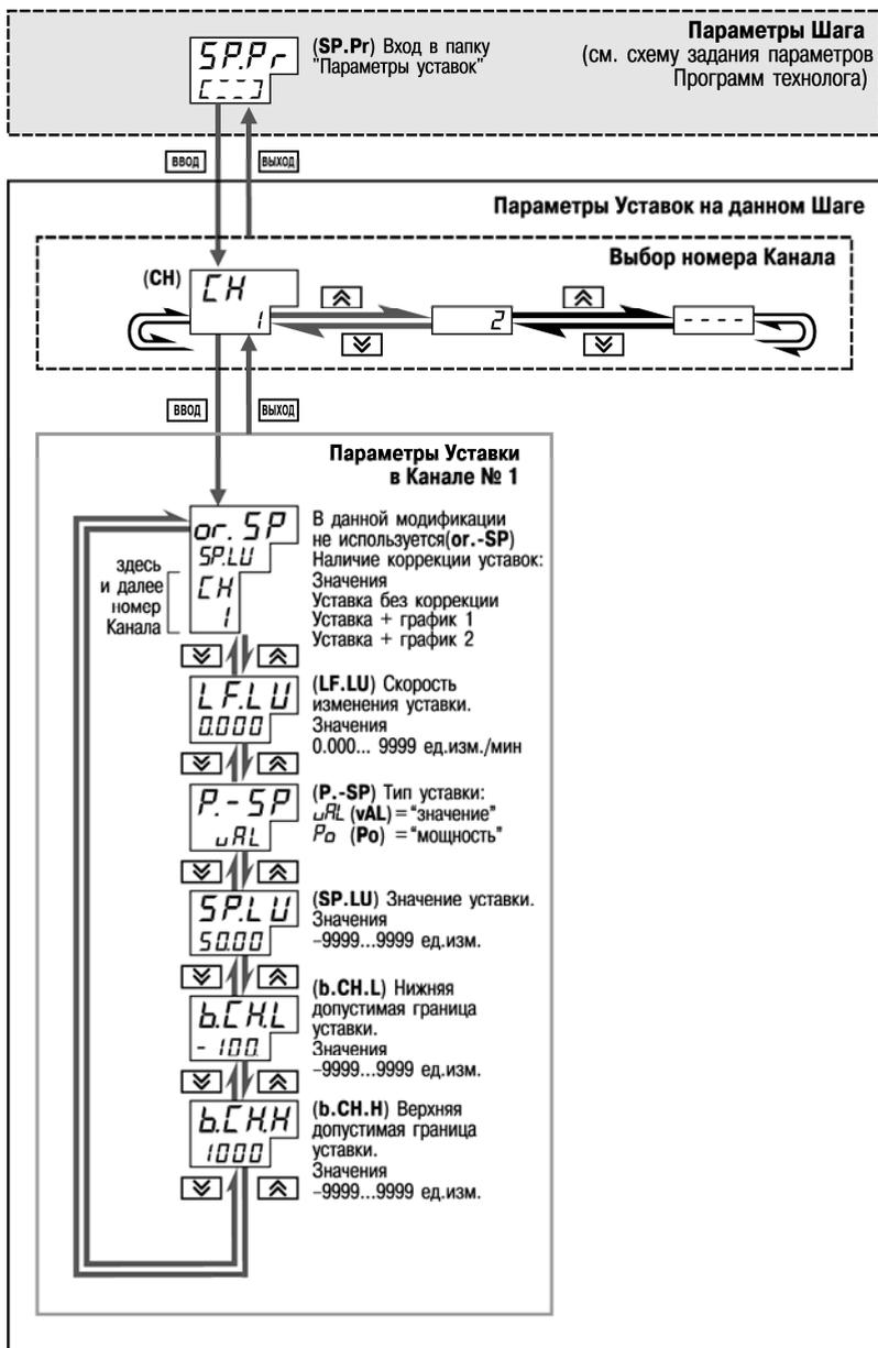
Рисунок 11.16 – Схема задания параметров Программ технолога и Уставок (продолжение). Задание параметров Уставок на данном Шаге Программы
