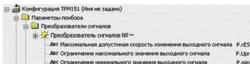
**Пример** - В климатикамере нельзя допустить, чтобы нагреватель работал менее чем на 20 % своей мощности. Для выполнения этого условия нужно установить **Минимальную выходную мощность P.min «20.0»**.
