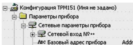
**Пример.** Для прибора № 1 **Базовый адрес** равен 16. Тогда для прибора № 2 задается **Базовый адрес** 24, для прибора № 3 – 32 и т. д.
