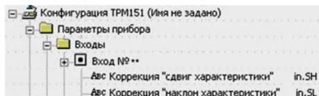
**Примечание** – При работе с платиновыми термопреобразователями сопротивления на заданное в параметре **in.SH** значение сдвига накладывается также коррекция нелинейности НСХ датчика, заложенная в программе обработки измерений.
