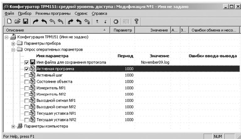
Рисунок 10.7 – Регистрация оперативных параметров в Конфигураторе
