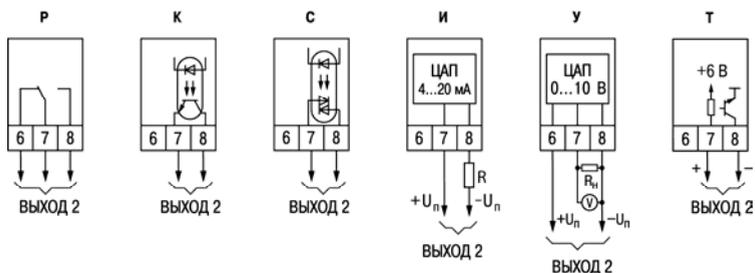
Рисунок Б.3 – Схемы подключения различных модификаций ВЭ2
