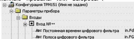
В случае помехи этот факт подтвердится повторным измерением и ложное измерение аннулируется. Такой алгоритм позволяет защитить прибор от воздействия единичных импульсных и коммутационных помех, возникающих на производстве при работе силового оборудования.
