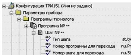
Нециклическая Программа в ТРМ151-03 (рисунок 3.3, а, б) состоит из последовательности «обычных шагов» и «шагов с переходом», которая заканчивается Шагом типа «конец программы».
