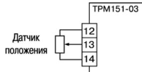
**Рисунок 7.8 – Схема подключения датчиков положения резистивного типа**
