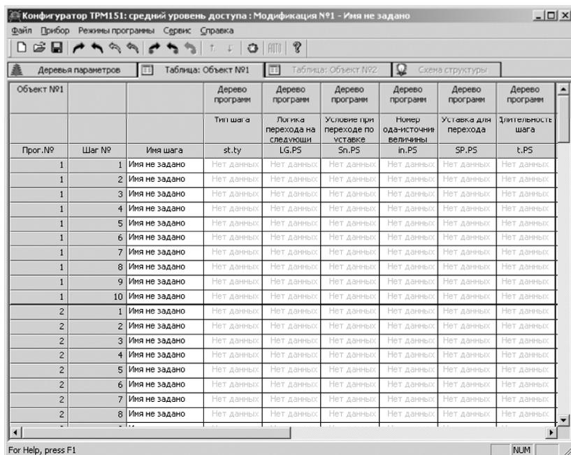
Рисунок 10.6 – Рабочее окно программы «Конфигуратор ТРМ151». Лист «Таблица программ»
