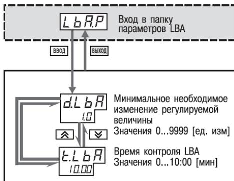
Рисунок 11.13 - Схема задания параметров контроля LBA-аварии
