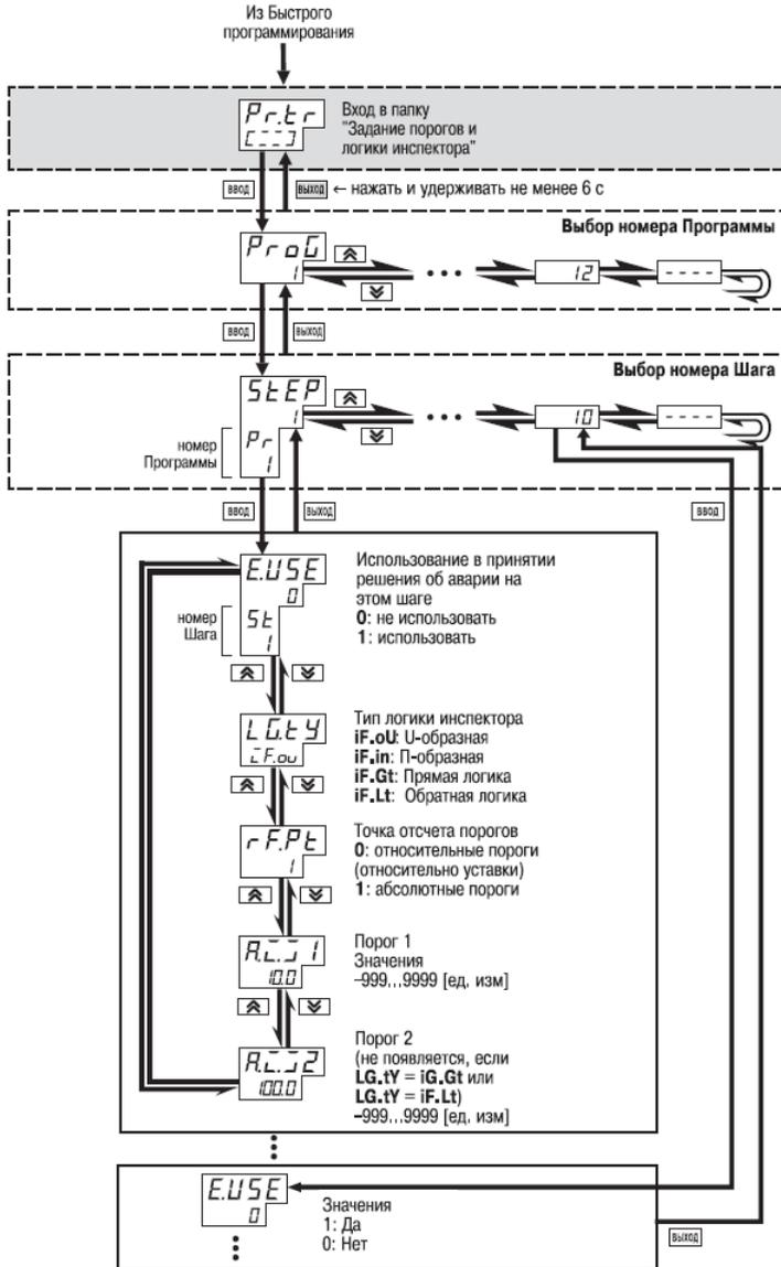
Рисунок 11.17 - Схема задания порогов и логики Инспектора
