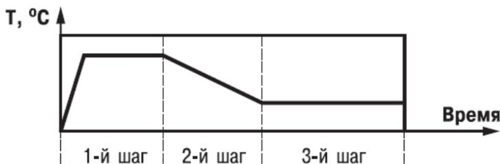
**Рисунок 3.3 - Пример Программы технолога для ТРМ151-04**
