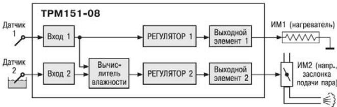
**TPM 151-08.** Одновременное пошаговое регулирование температуры и влажности. Вычисление влажности производится психрометрическим методом по температуре •сухого- и -влажного\* термометров.
