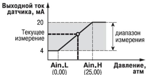
Рисунок 3.5 - Пример задания диапазона измерения активного датчика
