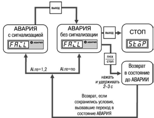
Рисунок 12.4 - Схема переключений состояний при АВАРИИ
