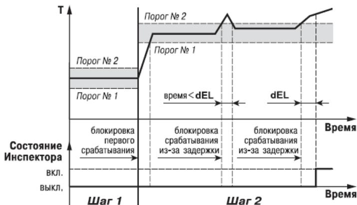
Рисунок 3.9 - Пример логики работы и блокировок срабатывания Инспектора
