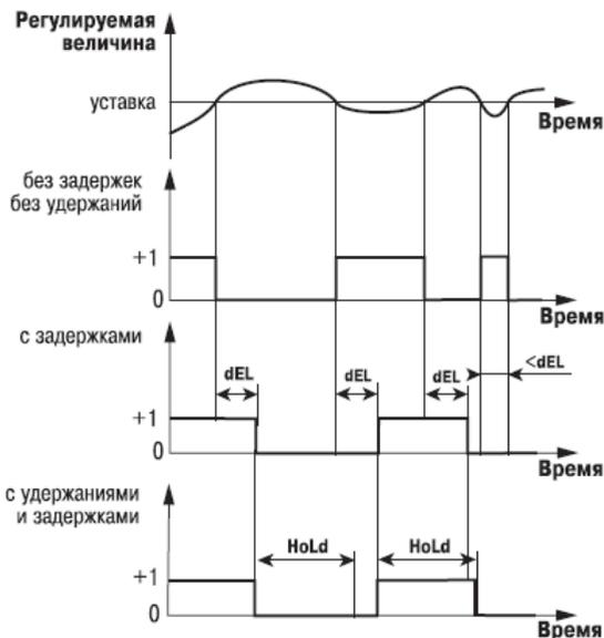
Рисунок 3.8 - Работа регулятора с заданными задержками и удержаниями
