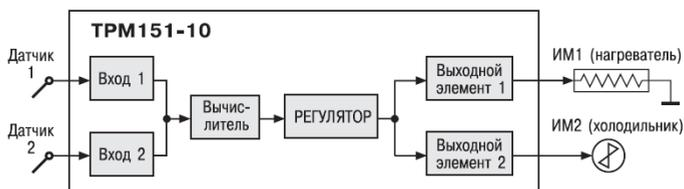
**ТРМ 151-10.** Одноканальное пошаговое регулирование с помощью системы «нагреватель - холодильник» по измеренной или вычисленной величине.
