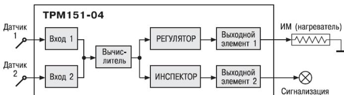
**ТРМ 151-04.** Одноканальное пошаговое регулирование по измеренной или вычисленной величине. Имеется блок контроля нахождения величины в допустимых границах (Инспектор). Сигнал от Инспектора подается на Выходной элемент 2, к которому подключается средство аварийной сигнализации (лампа, звонок и т. д.).
