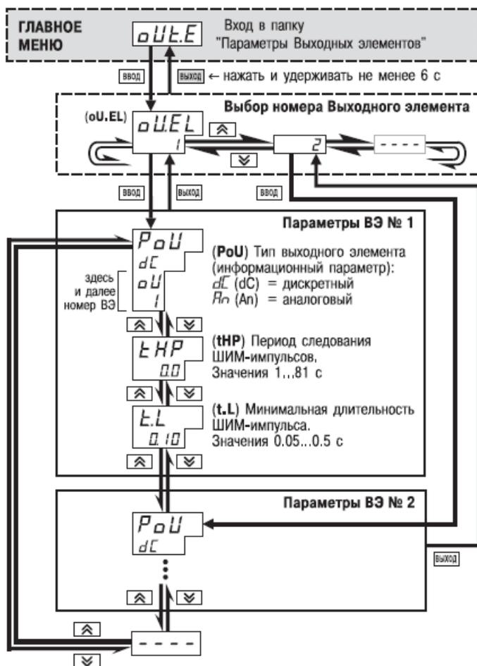
Рисунок 11.15 - Схема задания параметров Выходных элементов
