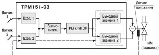
**ТРМ 151-03.** Одноканальное пошаговое регулирование задвижкой с датчиком положения или без.
