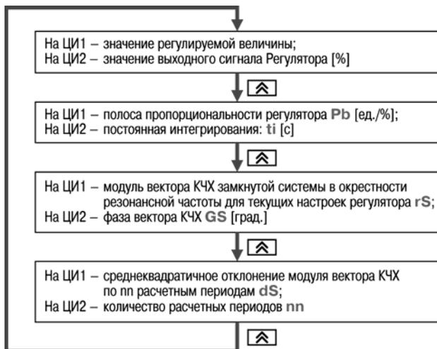
Рисунок 12.3 - Схема переключения индикации в режиме Автонастройки
