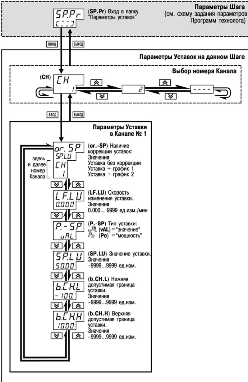
Рисунок 11.19 - Схема задания параметров Программ технолога и Уставок (продолжение).
