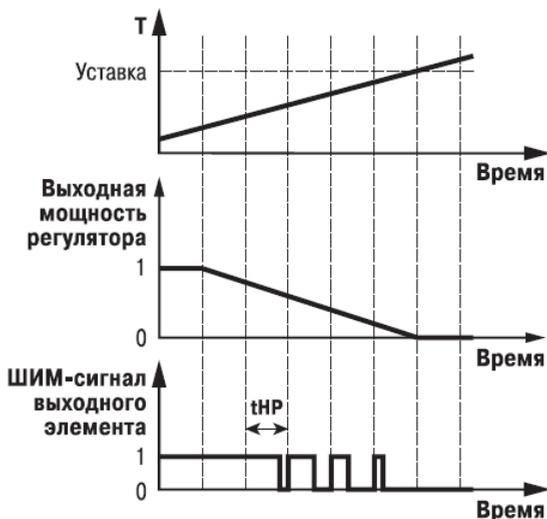
Рисунок 3.6 - Принцип формирования ШИМ-сигнала для «нагревателя»
