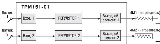
**ТРМ 151-01.** 2 Канала пошагового регулирования по измеренной величине, каждый Канал подключен к своему Выходному элементу. Регулятор может работать в режимах ПИД и ON/OFF.
