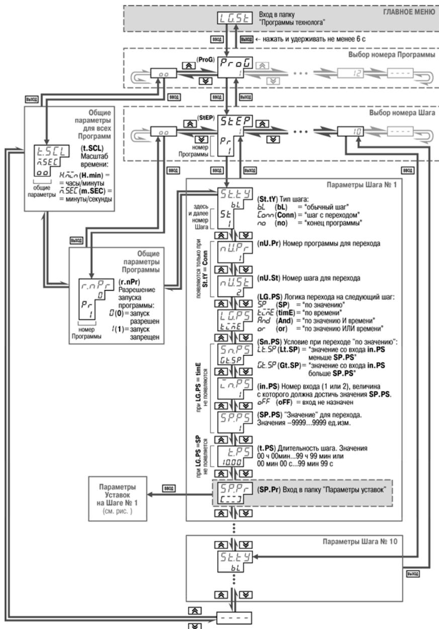
Рисунок 11.18 - Схема задания параметров Программ технолога и Уставок
