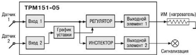
**TPM 151-05.** Одноканальное пошаговое регулирование, при этом Уставка Регулятора может быть скорректирована по определенной функции от значения, измеренного на Входе 2. Имеется блок Инспектора, соединенный с ВЭ2.
