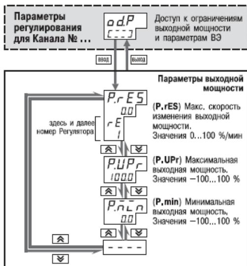
Рисунок 11.14 - Схема задания основных параметров конфигурации (продолжение).
