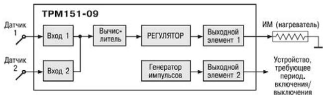
**ТРМ 151-09.** Одноканальное пошаговое регулирование по измеренной или вычисленной величине. На второй выход прибора можно на определенном шаге программы подать периодические импульсы для включения дополнительного оборудования или сигнализации о ходе технологического процесса.
