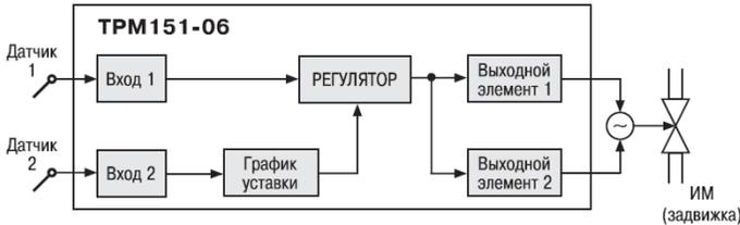
**TPM151-06.** Одноканальное пошаговое регулирование задвижкой без датчика положения. При этом Уставка Регулятора может быть скорректирована по определенной функции от значения, измеренного на Входе 2.
