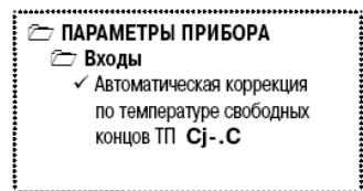
Отключение этого вида коррекции может быть необходимо, например, при проведении поверки прибора. При отключенном коррекции температура свободных концов термопар принимается равной 0 °C и ее возможные изменения в расчет не принимаются.
