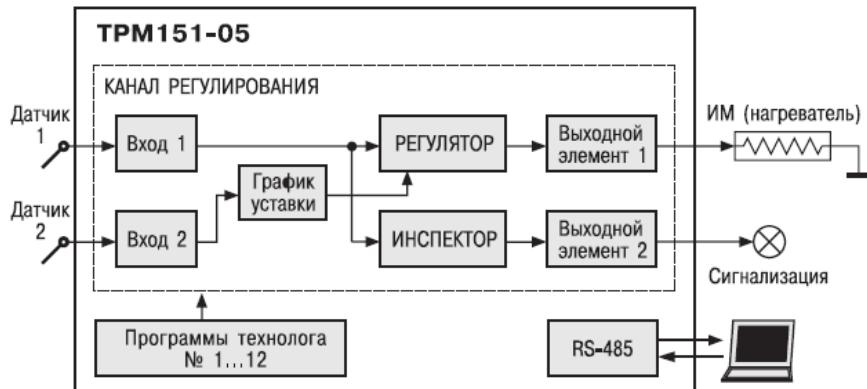
Рисунок 3.1 - Структурная схема TPM 151-05
