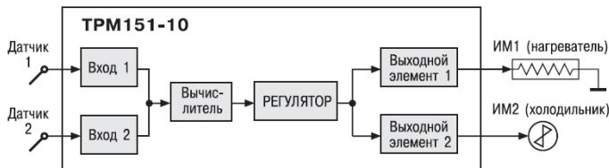
**TPM 151-10.** Одноканальное пошаговое регулирование с помощью системы «нагреватель - холодильник» по измеренной или вычисленной величине.
