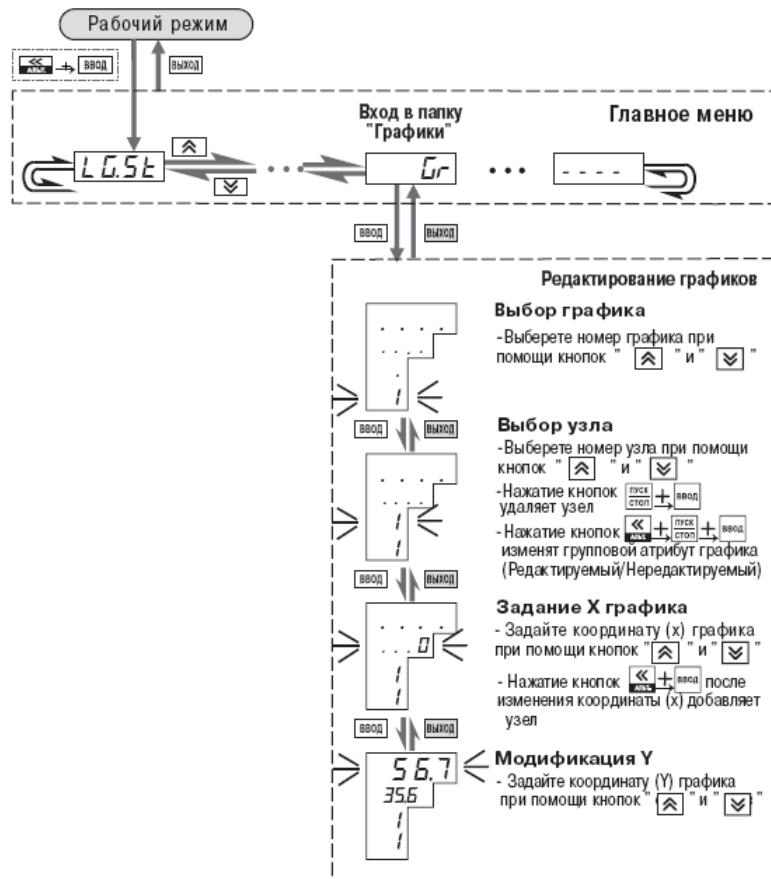
Рисунок 11.19 - Задание и редактирование графика коррекции уставки
