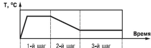
**Рисунок 3.2 - Пример Программы технолога для TPM151-05**
