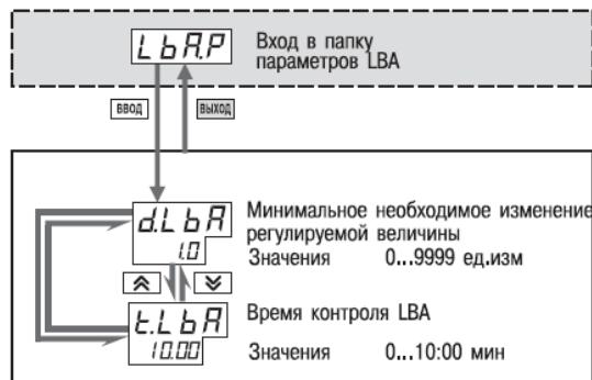
Рисунок 11.13 - Схема задания параметров контроля LBA-аварии
