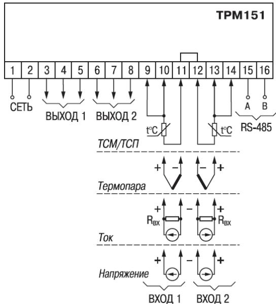
Рисунок Б.1 - Общая схема подключения TPM151-05
