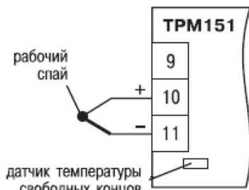
Рис. Г.2. Подключение термопары
