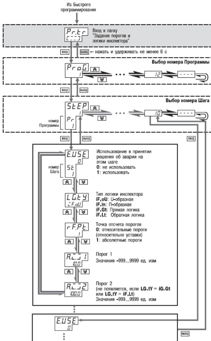
Рисунок 11.16 - Схема задания порогов и логики Инспектора
