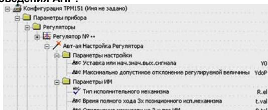
отклонение мощности», задающего отклонение мощности в процентах от установленного значения. Рекомендуемый интервал 5–10 %. Меньшее значение следует устанавливать при отсутствии в процессе настройки возмущающих воздействий на объект или при наличии ограничений на условия эксплуатации объекта.
