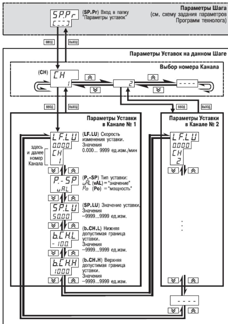
Рисунок 11.18 - Схема задания параметров Программ технолога и Уставок (продолжение).
