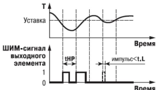
Рисунок 3.8 - Задание параметров ШИМ-сигнала
