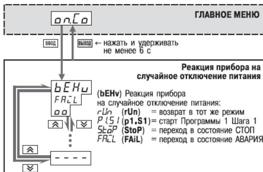
Рисунок 11.20 - Схема задания реакции на случайное отключение напряжения питания
