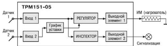
**TPM 151-05.** Одноканальное пошаговое регулирование, при этом Уставка Регулятора может быть скорректирована по определенной функции от значения, измеренного на Входе 2. Имеется блок Инспектора, соединенный с ВЭ2.
