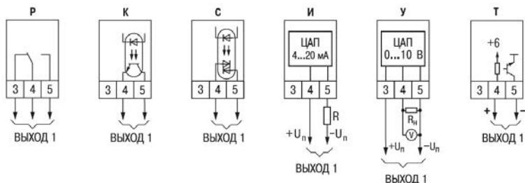
Рисунок Б.2 – Схемы подключения различных модификаций
