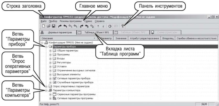
**Рисунок 10.5 – Рабочее окно программы «Конфигуратор TPM151».
