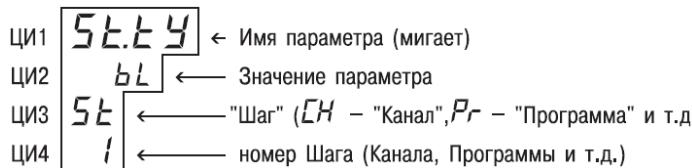
Рисунок 11.3 – Показания цифровых индикаторов при задании параметров
