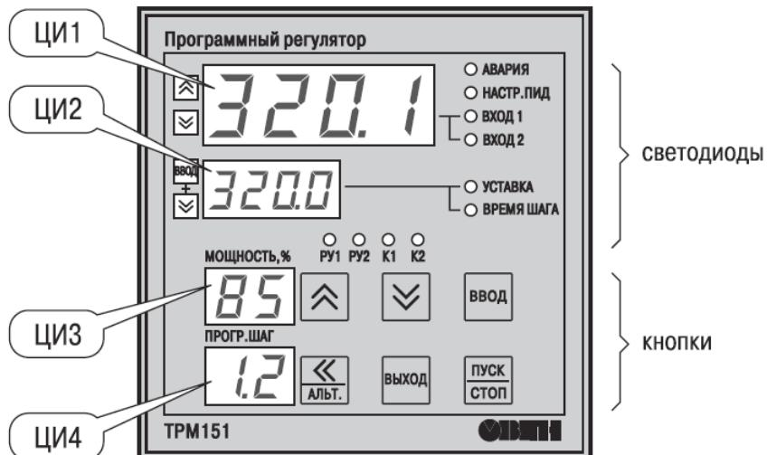
Рисунок 5.1 – Лицевая панель прибора
