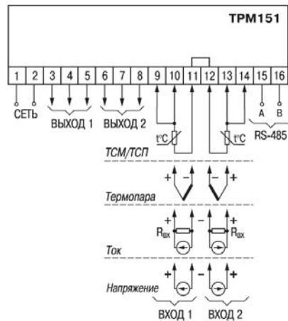
Рисунок Б.1 – Общая схема подключения TPM151-06
