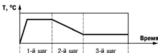
Рисунок 3.2 – Пример Программы технолога для TPM151-06
