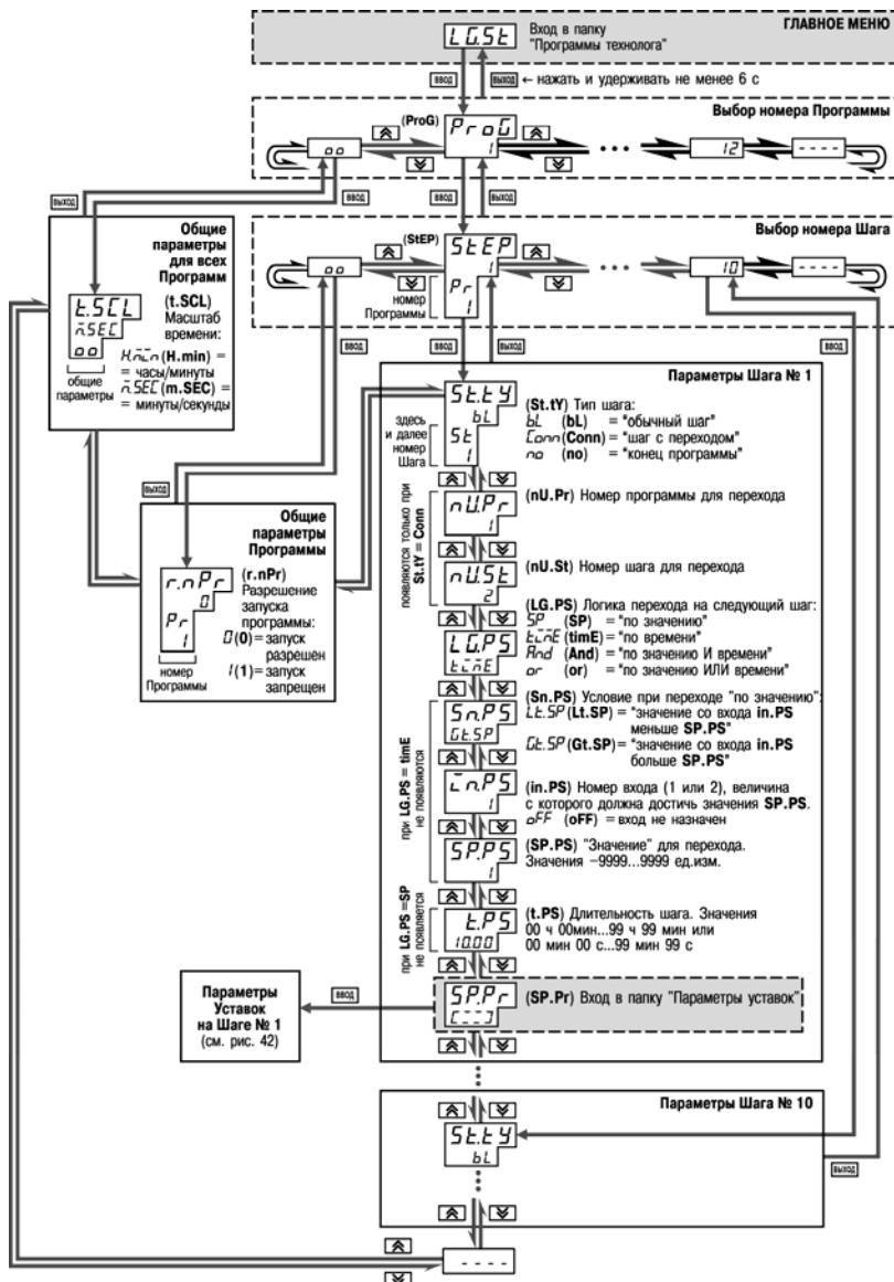
Рисунок 11.14 – Схема задания параметров Программ технологов и Уставок
