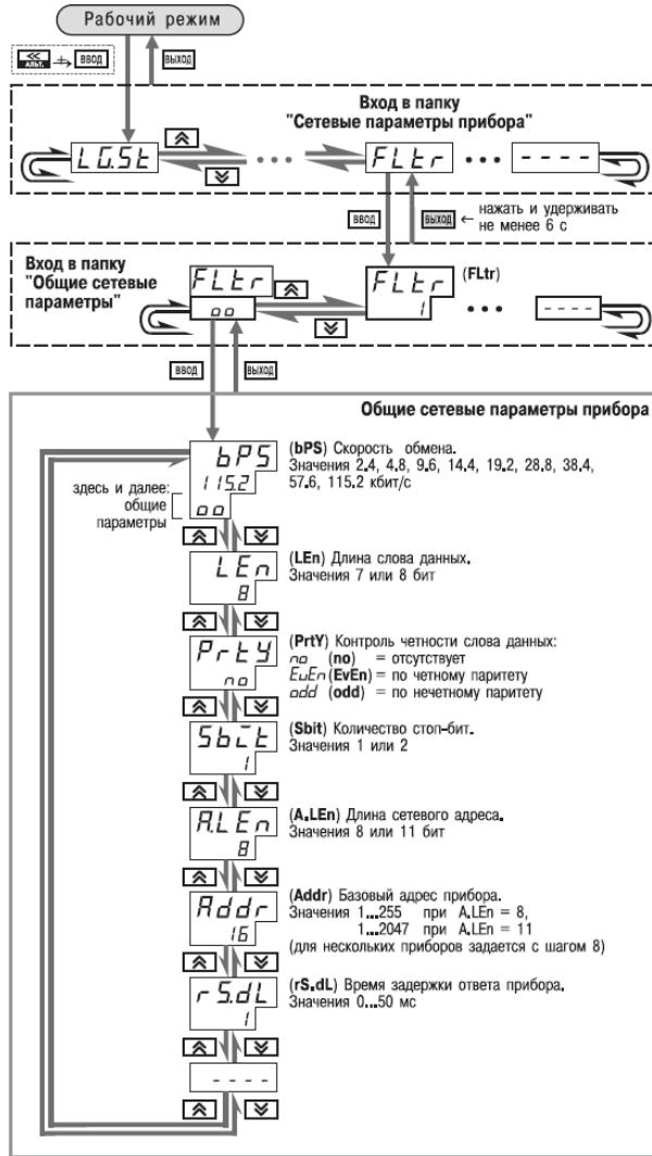
Рисунок 9.1 – Схема задания сетевых параметров прибора
