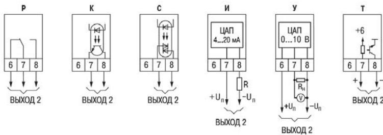
Рисунок Б.3 – Схемы подключения различных модификаций
