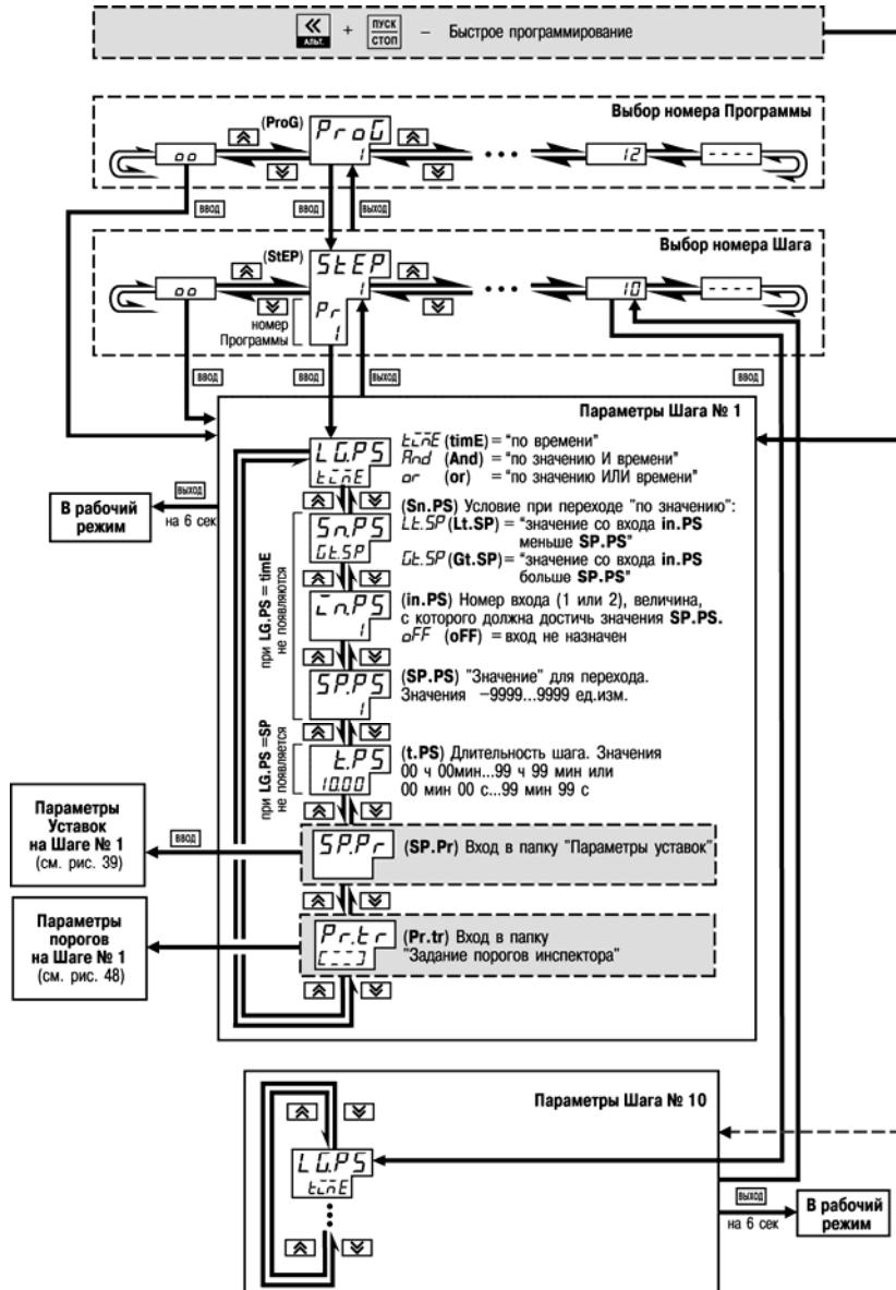
Рисунок 11.7 – Схема задания параметров программ технолога
