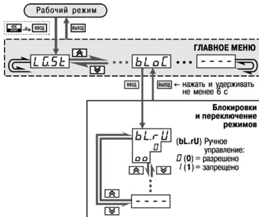
Рисунок 12.1 – Схема установки параметра
