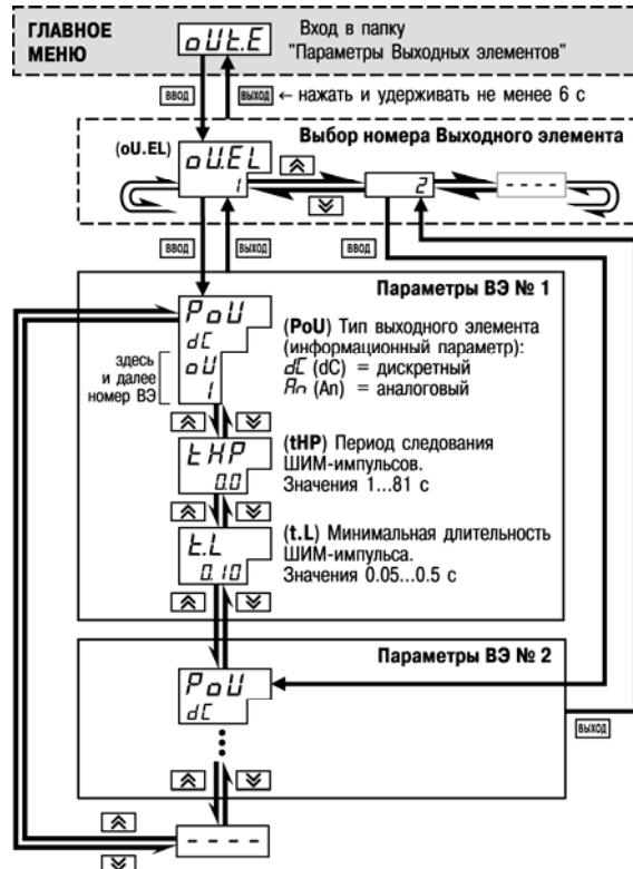
Рисунок 11.14 - Схема задания параметров Выходных элементов
