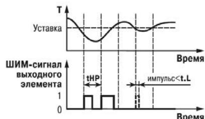
Рисунок 3.8 – Задание параметров ШИМ-сигнала
