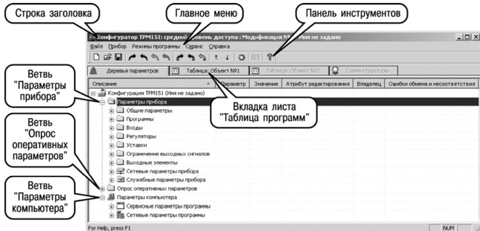
**Рисунок 10.5 – Рабочее окно программы «Конфигуратор TPM151».
