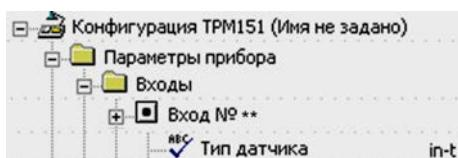
**Внимание!** При неправильном задании значения параметра Тип датчика прибор будет производить некорректные измерения!
