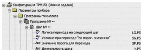
**Логика перехода** на следующий Шаг задается параметром **LG.PS**.
