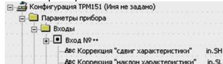
погрешности первичного преобразователя (например, значения  $R_0$  у термопреобразователей сопротивления).
