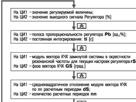
Рисунок 12.3 – Схема переключения индикации в режиме Автонастройки
