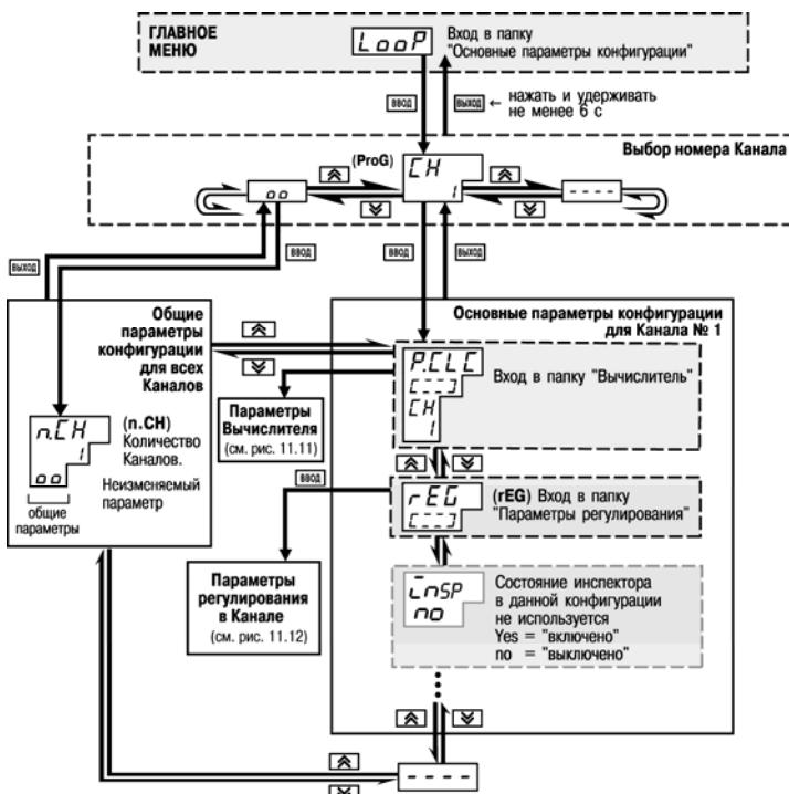
Рисунок 11.9 – Схема задания основных параметров конфигурации
