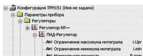
Для эффективной работы ПИД-регулятора необходимо подобрать для конкретного объекта регулирования значения коэффициентов ПИД-регулятора  $X_p$ ,  $t_i$  и  $\tau_d$  (соответственно, параметры  $Pb$ ,  $ti$  и  $td.ti$ , последний задается как отношение  $\tau_d/ti$ ).
