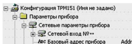
**Базовый адрес** прибора TPM151 = **Базовый адрес** предыдущего прибора + 8.
