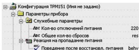
3.11.2 Прибор производит подсчет случайных отключений питания (параметр **220**). Кроме того, прибор подсчитывает количество собственных пересбросов (параметр **rES**), которые могут происходить при отсутствии питания длительное время.
