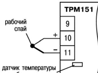
Рисунок Г.2 – Подключение термопары
