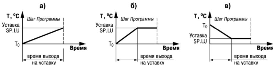
$$\text{Скорость выхода на уставку LF.LU} = \frac{\text{Уставка SP.LU} - T_0}{\text{время выхода на уставку}} \quad [\text{ед. изм.}] \quad [\text{мин.}]$$
