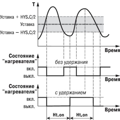
**Рисунок К.2 – Работа двухпозиционного регулятора с удержанием ИМ
