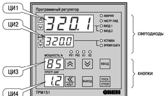
Рисунок 5.1 – Лицевая панель прибора
