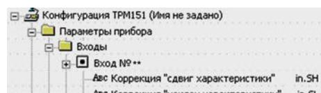
**Примечание** – При работе с платиновыми термопреобразователями сопротивления на заданное в параметре **in.SH** значение сдвига накладывается также коррекция нелинейности НСХ датчика, заложенная в программе обработки измерений.
