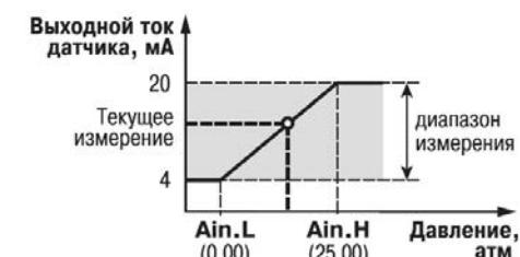
Рисунок 3.4 – Пример задания диапазона измерения активного датчика
