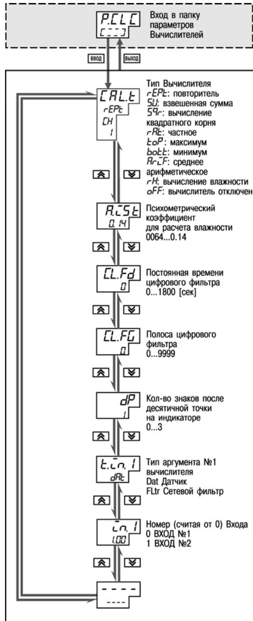
Рисунок 11.11 – Схема задания параметров Вычислителей
