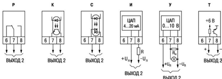
Рисунок Б.3 – Схемы подключения различных модификаций ВЭ2
