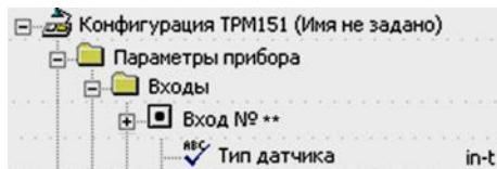
**Внимание!** При неправильном задании значения параметра **Тип датчика** прибор будет производить некорректные измерения!
