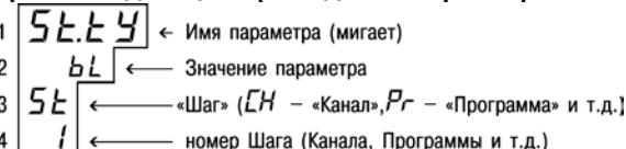
Рисунок 11.3 – Показания цифровых индикаторов при задании параметров
