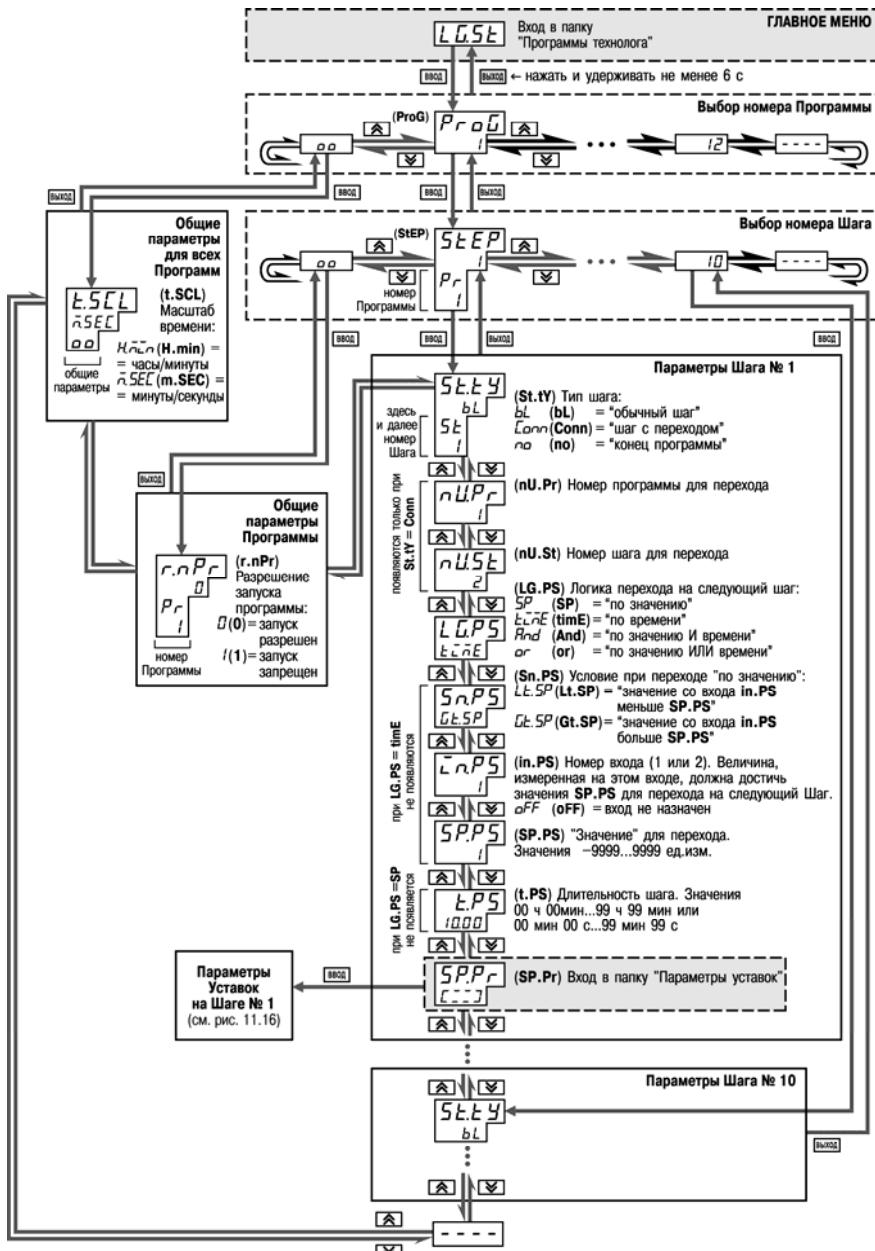
Рисунок 11.16 – Схема задания параметров Программ технолога и Уставок
