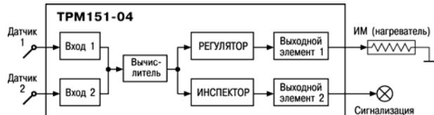
(Инспектор). Сигнал от Инспектора подается на Выходной элемент 2, к которому подключается средство аварийной сигнализации (лампа, звонок и т. д.).
