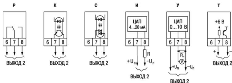
Рисунок Б.2 – Схемы подключения различных модификаций ВЭ1
