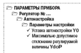
будет недостаточным, и его параметры будут определены неточно. При регулировании температуры оптимальное значение  $YdP$  находится в диапазоне 5...30 °C.
