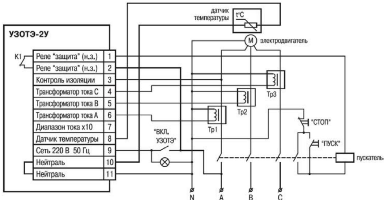
Рисунок Б.1 – Схема подключения УЗОТЭ-2У
