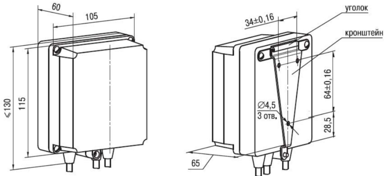
**Рисунок А.1 – Габаритные и установочные размеры УЗОТЭ-2У**
